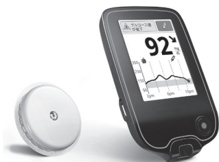
写真右: FGMの本体(リーダー) 写真左: 腕に貼付するセンサー
